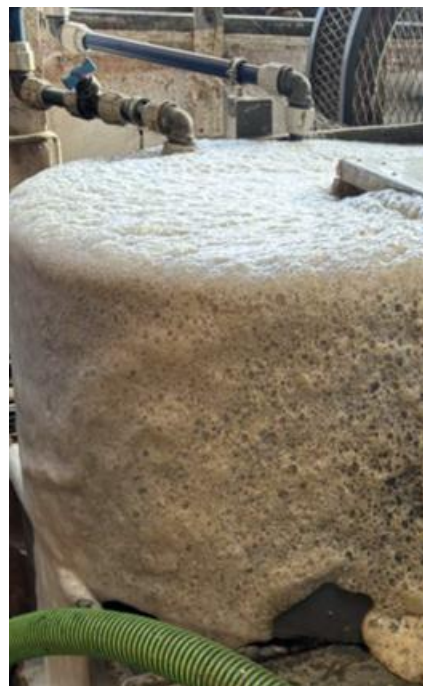
Abbildung 31: Schaumbildung durch die Zugabe der Nasswiesenbiomasse in den Pulper. Links: Schaumbildung vor Zugabe und rechts: sehr starke Schaumbildung mit Überlauf nach Zugabe des Leimungsmittels.
