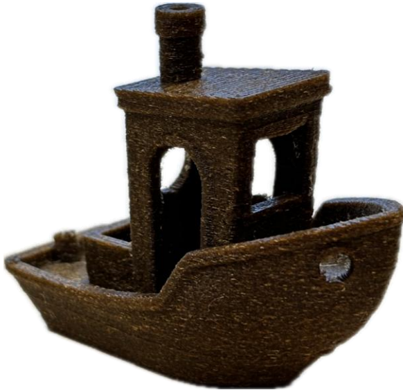
Abbildung 40: 3D-Gedrucktes Benchy (Boot) aus 10% Carex 90% PLA4043D Compound
