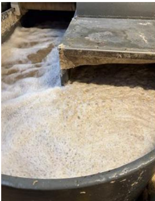
Abbildung 31: Schaumbildung durch die Zugabe der Nasswiesenbiomasse in den Pulper. Links: Schaumbildung vor Zugabe und rechts: sehr starke Schaumbildung mit Überlauf nach Zugabe des Leimungsmittels.
