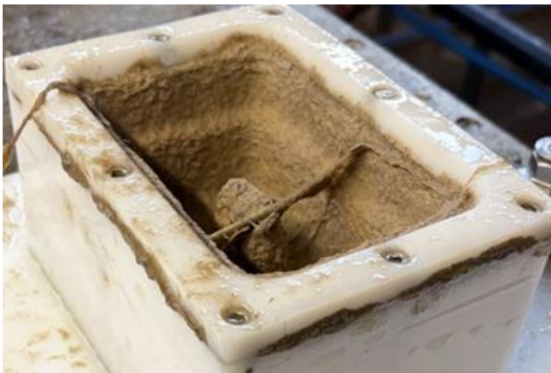
Abbildung 32: Störung der Werkzeugdichtigkeit durch grobe Pflanzenteile.
