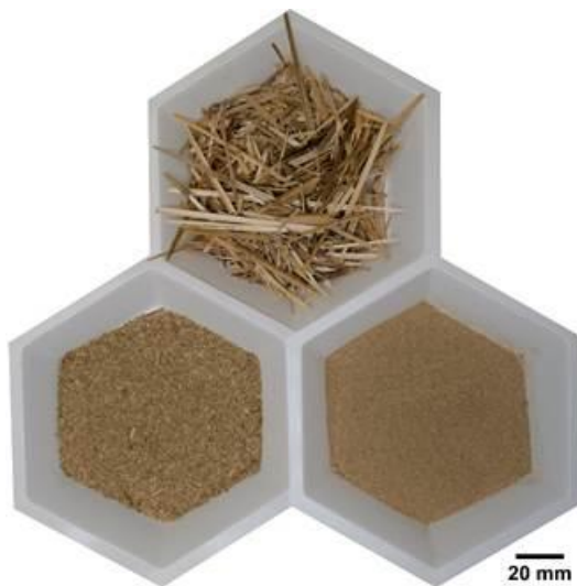
Abbildung 34: Darstellung der drei unterschiedlichen Biomasseaufbereitungsarten, exemplarisch am Beispiel von Phragmites australis ; oben: grob gehäckselte, unten links: Zerkleinerung mit Ultrazentrifugalmühle, rechts unten: Feinvermahlen im industriellen Maßstab.
